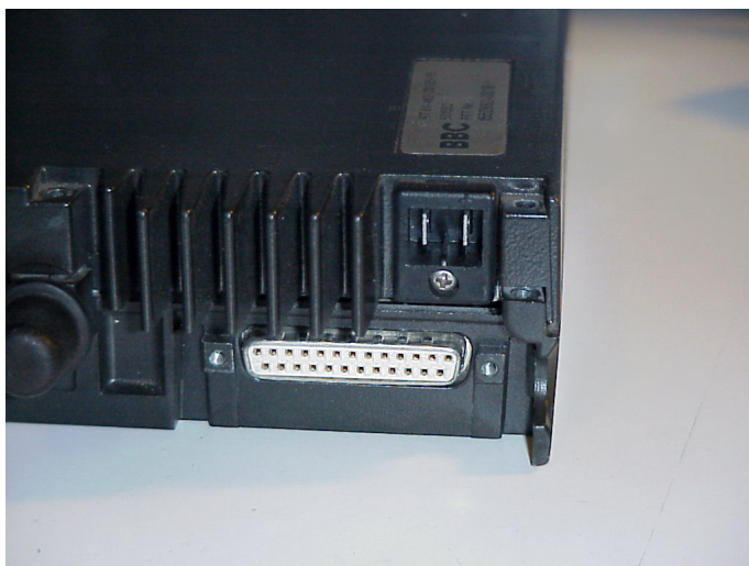
Numérotation des pins de la prise châssis (femelle) DB-25
